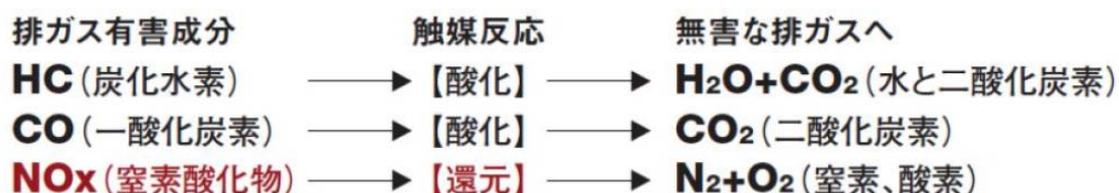
現在のガソリン車用三元触媒の成分は、白金（プラチナ）、パラジウム、ロジウムの3つに絞られている。いわゆる希少貴金属だ。それをアルミナの粉体に混ぜ込んで担体の通路表面にコーティングする。また、それぞれの貴金属の機能も決まっているほか、貴金属の使用量を減らす工夫が行なわれている。1970年代に発明された三元触媒だが、その姿は刻々と進化しており、性能もどんどんアップしているのが現状である。
