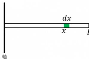
端点からの距離が $x$ から $x + dx$ の間にある部分の質量は $M \cdot \frac{dx}{L}$ なので、
